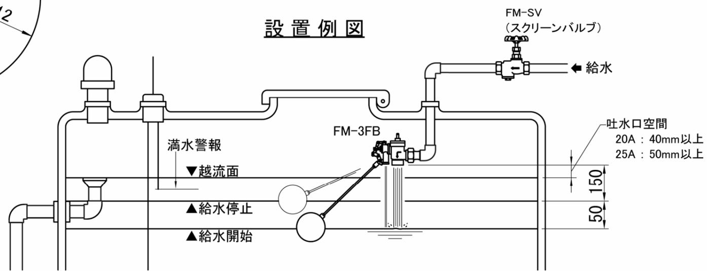
※ 水位は水槽の大きさ、水圧および流量調整棒の開度等の条件により変わる場合があります。
