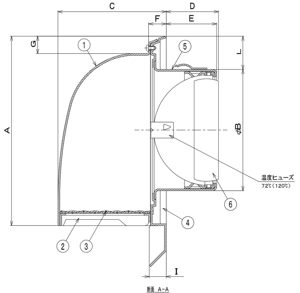
本体取付ビス: ST3. 5×30 十字穴付皿タップピン SUS305製 (2ヶ所)
