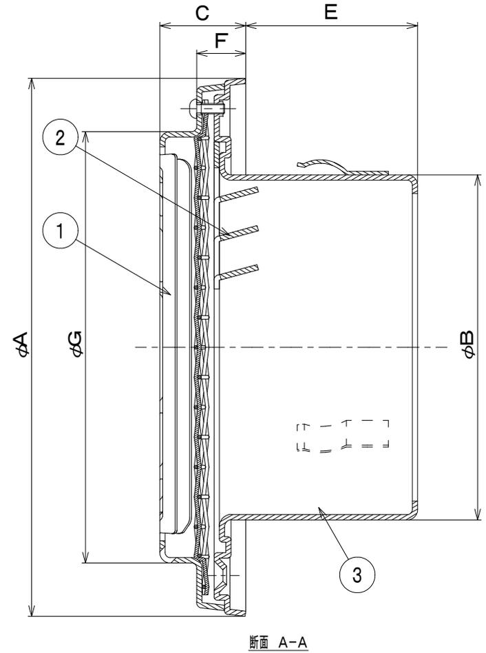
本体取付ビス: ST3. 5×30 十字穴付タッピンねじ SUS305製(3ヶ所)
